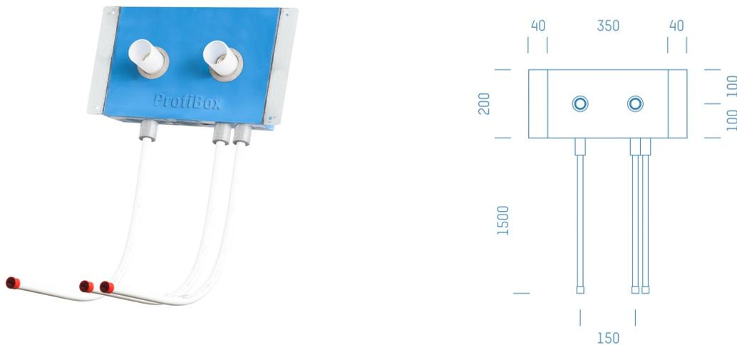
Sanitärmodul f. Badewannen Zirkulation mit Spritzwasserhülsen nur Kaltwasser, Boxenstärke: 5cm, Trockenbau, DN15, Geberit Mapress Edelstahl
