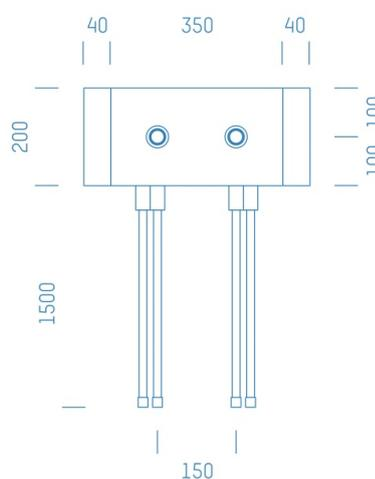
Sanitärmodul f. Badewannen Zirkulation mit Spritzwasserhülsen, Boxenstärke: 5cm, Trockenbau, DN20, PRINETO
