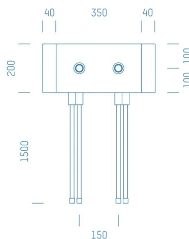
Sanitärmodul f. Badewannen Zirkulation mit Spritzwasserhülsen, Boxenstärke: 5cm, Trockenbau, DN16, WAVIN
