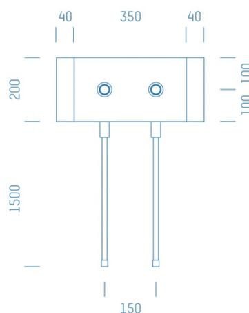
Sanitärmodul f. Badewannen mit Spritzwasserhülsen, Boxenstärke: 5cm, Trockenbau, DN20, WAVIN
