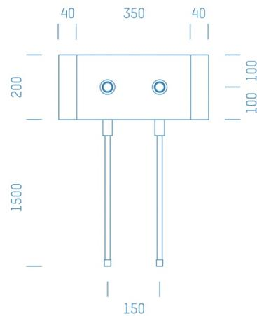
Sanitärmodul f. Badewannen mit Spritzwasserhülsen, Boxenstärke: 5cm, Trockenbau, DN20, VIEGA SANFIX FOSTA
