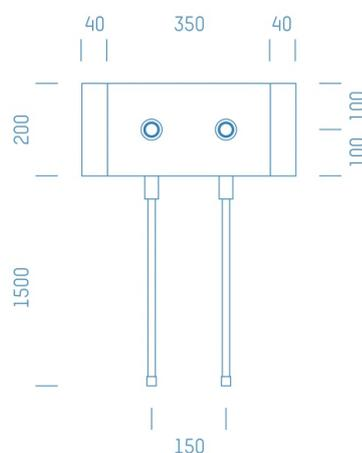
Sanitärmodul f. Badewannen mit Spritzwasserhülsen, Boxenstärke: 5cm, Trockenbau, DN16, RADOPRESS
