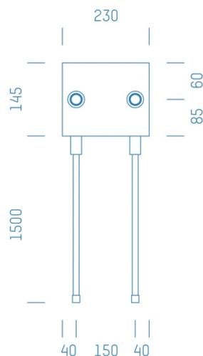
Sanitärmodul f. Badewannen mit Spritzwasserhülsen, Boxenstärke: 5cm, Mauerwerk, DN16, Alva Acta Aluverbundrohr
