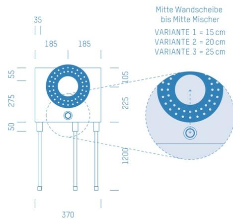
Sanitärmodul f. Badewannenmischkopf-Easybox, Handbrausen-Anschluss unten, Boxenstärke: 7cm, Mauerwerk, DN20, TECE
