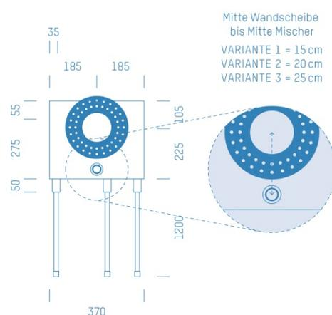
Sanitärmodul f. Badewannenmischkopf Kludi Flexx, Handbrausen-Anschluss unten, Boxenstärke: 7cm, Mauerwerk, DN20, VIEGA SANFIX FOSTA
