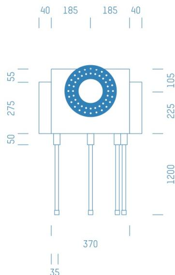
Sanitärmodul f. Badewannenmischkopf Kludi Flexx, 4 Rohre nach unten, Boxenstärke: 7cm, Trockenbau, DN20, VIEGA RAXOFIX
