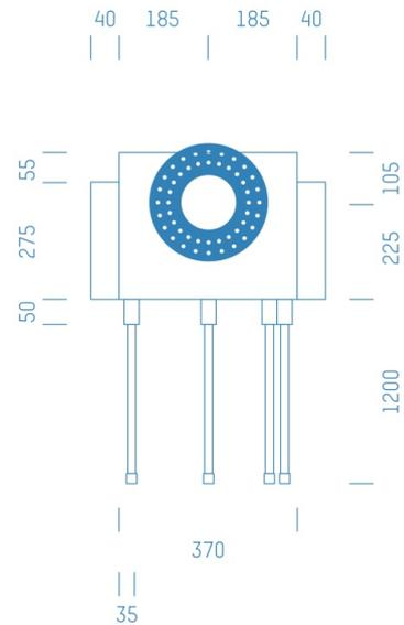
Sanitärmodul f. Badewannenmischkopf Kludi Flexx, 4 Rohre nach unten, Boxenstärke: 7cm, Trockenbau, DN20, RADOPRESS
