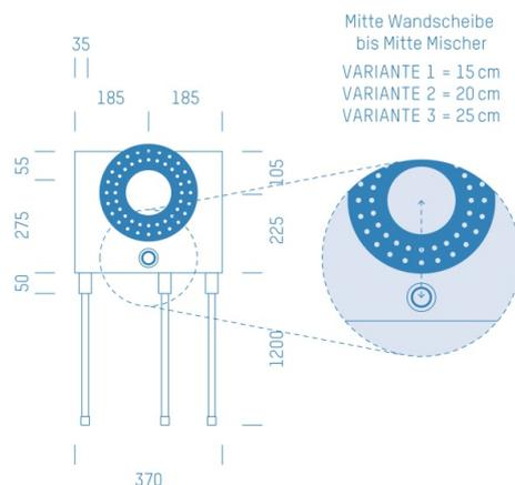
Sanitärmodul f. Badewannenmischkopf Hansabluebox+Absperrung, Handbrausen-Anschluss unten, Boxenstärke: 7cm, Mauerwerk, DN20, TECE
