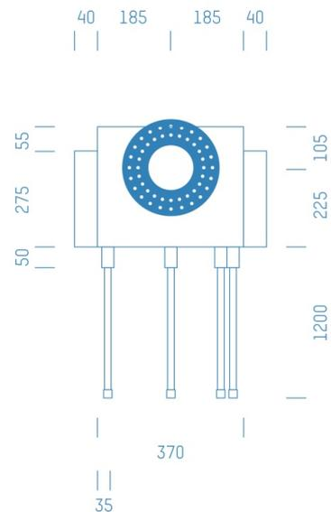
Sanitärmodul f. Badewannenmischkopf Hansabluebox+Absperrung, 4 Rohre nach unten, Boxenstärke: 7cm, Trockenbau, DN20, FRÄNKISCH ALPEX
