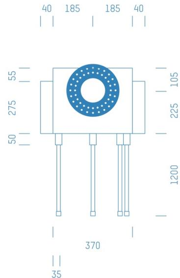
Sanitärmodul f. Badewannenmischkopf Hansabluebox+Absperrung, 4 Rohre nach unten, Boxenstärke: 7cm, Trockenbau, DN16, MAINPEX
