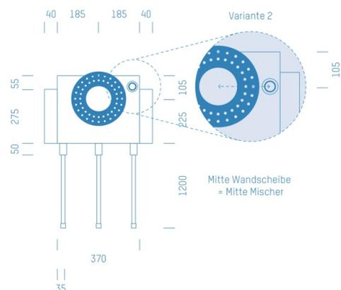
Sanitärmodul f. Badewannenmischkopf Hansabluebox+Absperung, Handbrausen-Anschluss rechts, Boxenstärke: 7cm, Trockenbau, DN16, KELOX
