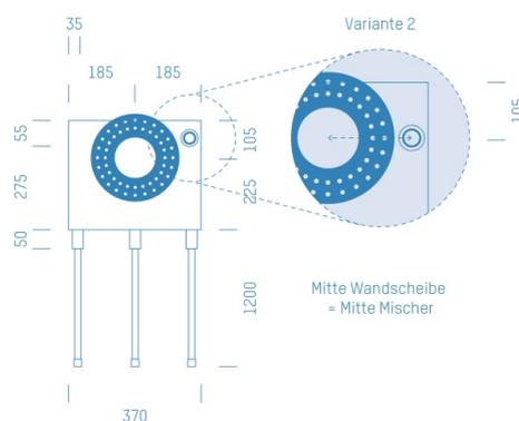
Sanitärmodul f. Badewannenmischkopf Hansabluebox+Absperung, Handbrausen-Anschluss rechts, Boxenstärke: 7cm, Mauerwerk, DN16, I-FIT
