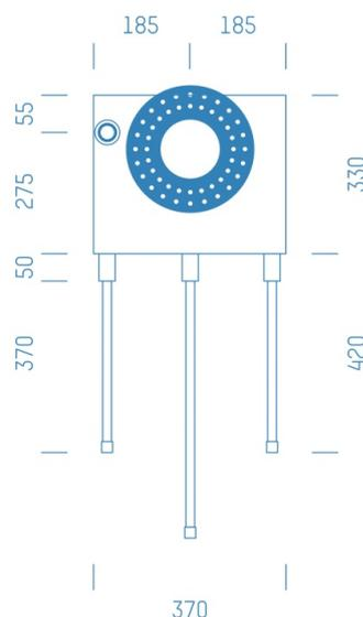
Sanitärmodul f. Badewannenmischkopf Hansabluebox+Absperrung, Handbrausen-Anschluss links, Boxenstärke: 7cm, Mauerwerk, DN18, Geberit Mapress Edelstahl
