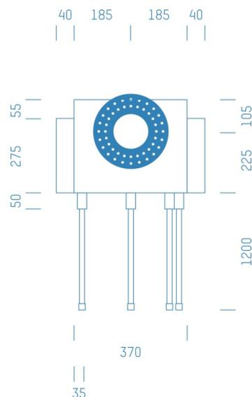
Sanitärmodul f. Badewannenmischkopf Hans Grohe I-Box 1800, 4 Rohre nach unten, Boxenstärke: 7cm, Trockenbau, DN20, WAVIN
