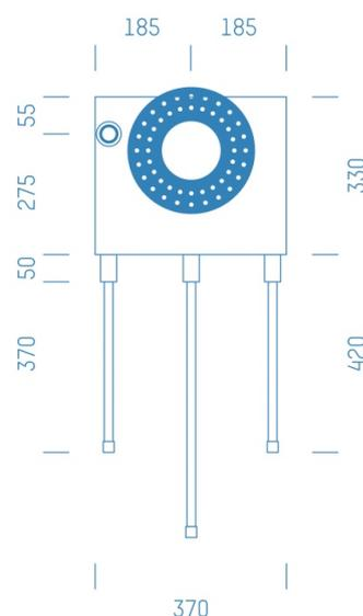
Sanitärmodul f. Badewannenmischkopf Hans Grohe I-Box 1800, Handbrausen-Anschluss links, Boxenstärke: 7cm, Mauerwerk, DN16, VIEGA RAXOFIX
