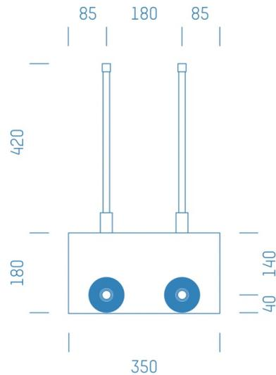
Sanitärmodul f. Absperrventil 1/2" Kludi KW+WW, Boxenstärke: 7cm, Mauerwerk, DN20, WINKLER
