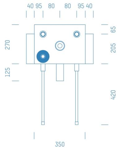
Sanitärmodul f. Waschtisch mit Absperrung Warmwasser Kludi 3/4", Boxenstärke: 7cm, Trockenbau, DN20, Rohrführung von unten, Alva Acta PE System, Abfluss: JH exklusiv Bogen
