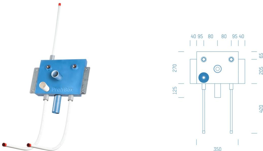
Sanitärmodul f. Waschtisch mit Absperrung Warmwasser Kludi 3/4", Boxenstärke: 7cm, Trockenbau, DN20, Rohrführung von unten, ALFASAN, Abfluss: Geberit geschweißt
