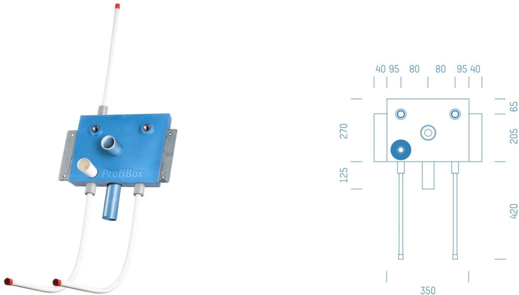
Sanitärmodul f. Waschtisch mit Absperrung Warmwasser Kludi 3/4", Boxenstärke: 7cm, Trockenbau, DN20, Rohrführung von unten, ALFASAN, Abfluss: Polokal NG
