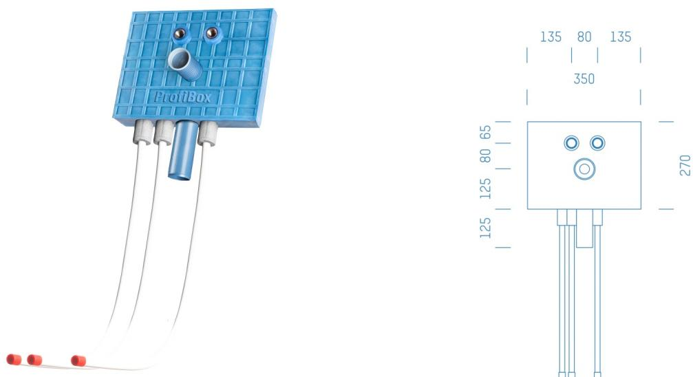
Sanitärmodul f. Waschtisch Zirkulation nur Warmwasser, Boxenstärke: 7cm, Mauerwerk, DN20, WAVIN, Rohrführung von oben, Abfluss: Master 3
