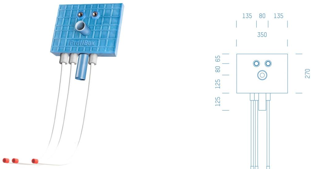
Sanitärmodul f. Waschtisch Zirkulation nur Warmwasser, Boxenstärke: 7cm, Mauerwerk, DN20, WAVIN, Rohrführung von oben, Abfluss: Conel Drain
