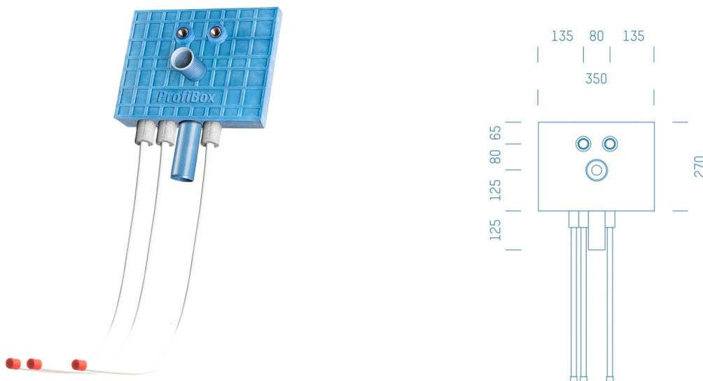
Sanitärmodul f. Waschtisch Zirkulation nur Warmwasser, Boxenstärke: 7cm, Mauerwerk, DN20, WINKLER, Rohrführung von oben, Abfluss: Polokal NG
