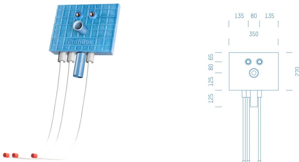
Sanitärmodul f. Waschtisch Zirkulation nur Warmwasser, Boxenstärke: 7cm, Mauerwerk, DN20, VIEGA SANFIX FOSTA, Rohrführung von oben, Abfluss: Rehau Raupiano
