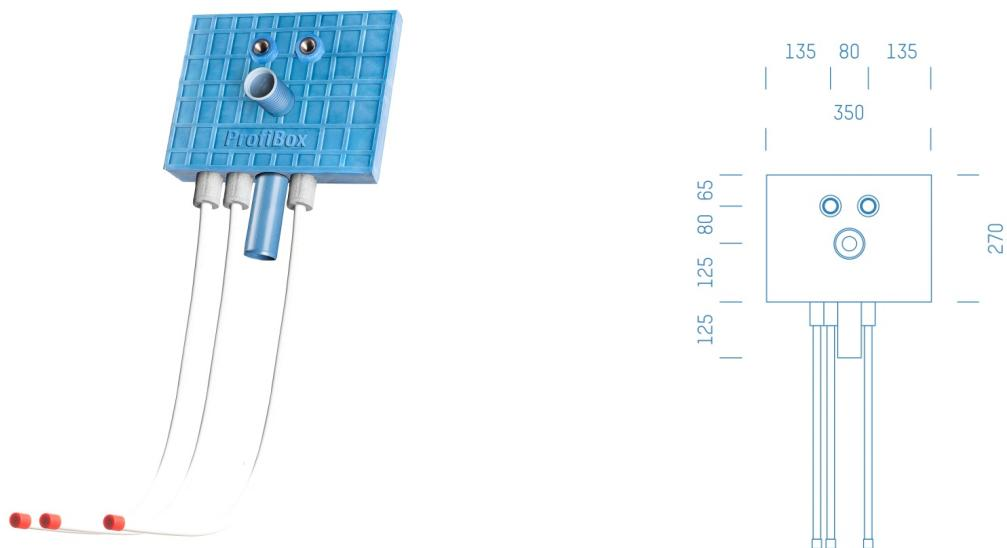
Sanitärmodul f. Waschtisch Zirkulation nur Warmwasser, Boxenstärke: 7cm, Mauerwerk, DN20, TECE, Rohrführung von unten, Abfluss: Conel Drain
